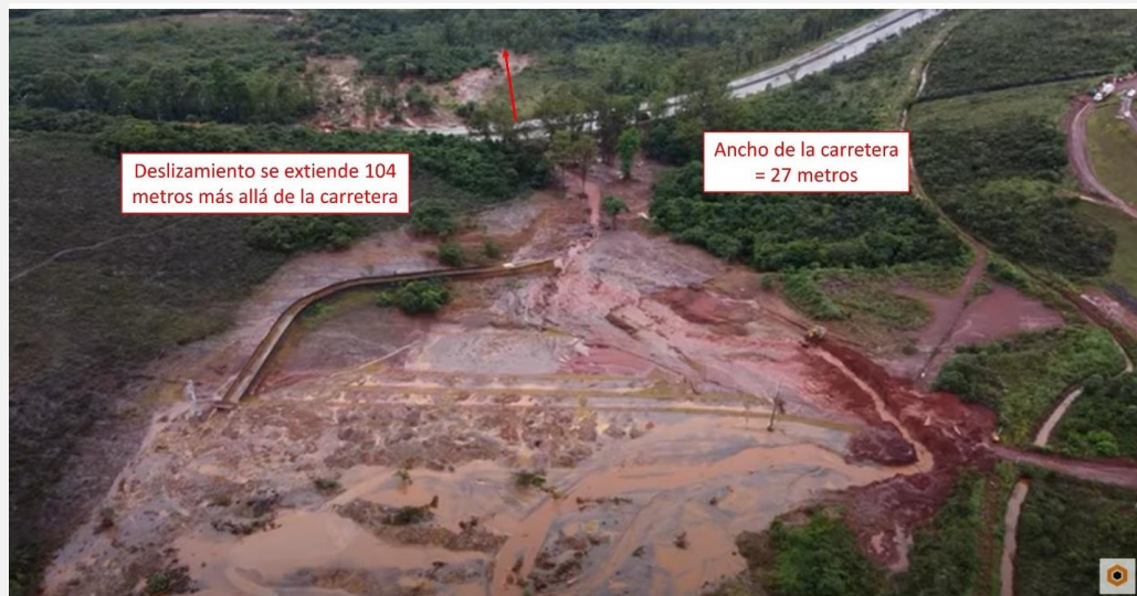
Ilustración 14a: Basado en el ancho de la carretera de 27 metros, el deslizamiento en la pila de relaves filtrados en la mina Pau Branco en Brasil el 8 de enero de 2022 (ver Fig. 8), se extendió por 104 metros más allá de la Carretera BR-40. El ancho de la carretera se midió a partir de una imagen de Google Earth del 29 de junio de 2022 (ver Fig. 14b). Imagen fija a las 0:38 del video del dron (Observatório da Mineração [Observatorio Minero], 2022).
